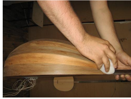
Resim 1.6: Gomlak cila sürülmesi
