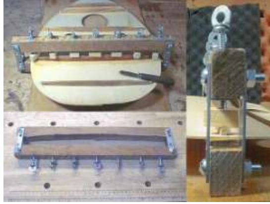
Resim 1.13: Balkonların tabloya yapıştırılmasında kullanılan bir kalıp
