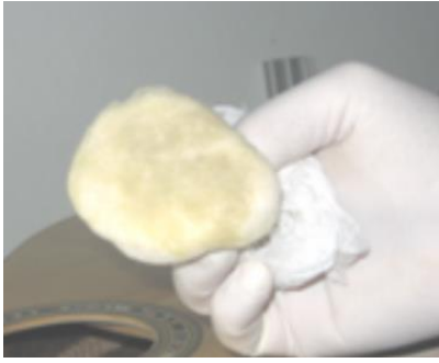
Resim 1.6: Gomlak cila sürülmesi
