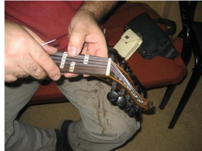
Resim 2.9: Tel yüksekliğinin ayarlanması
