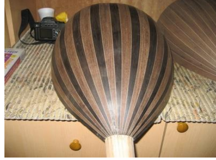
Resim 1.27: Poliř-pasta için ince zımpara uygulaması
