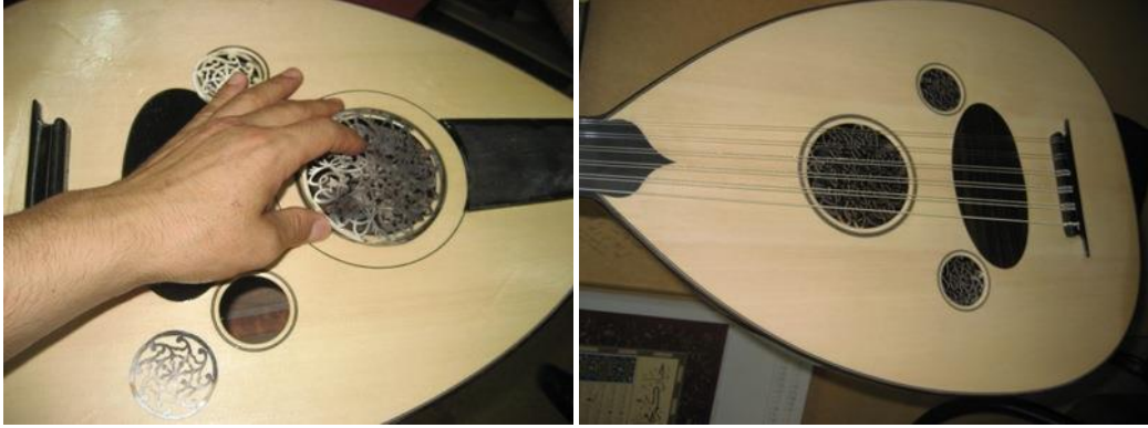
Resim 1.30: Kafeslerin yapıştırılması
