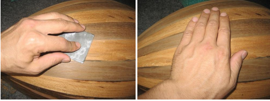
Resim 1.25: Dolgu verniği sonrası ince zımpara yapılması ve elle kontrol işlemi
