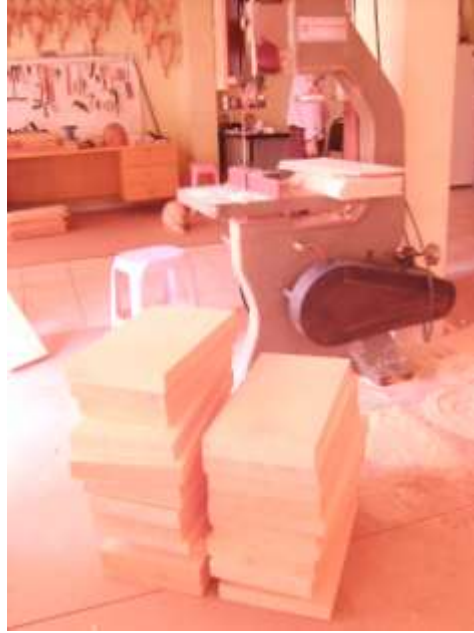
Resim 1.6: Kapak kalınlıklarının şerit testere makinesinde kaba kesilmesi
