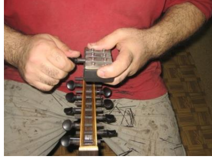
Resim 2.2: Burguların yerlerine alıştırılması
