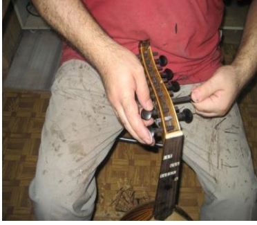
Resim 2.2: Burguların yerlerine alıştırılması
