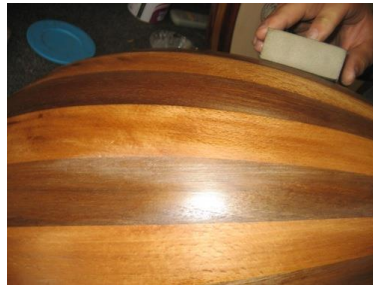
Resim 1.19: Kaba zımparalama ve zımpara takozu
