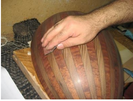
Resim 1.27: Poliř-pasta için ince zımpara uygulaması
