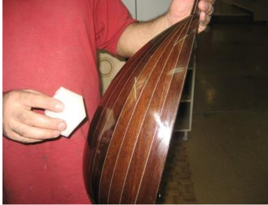
Resim 1.10: Sünger ile polyester vernik uygulaması
