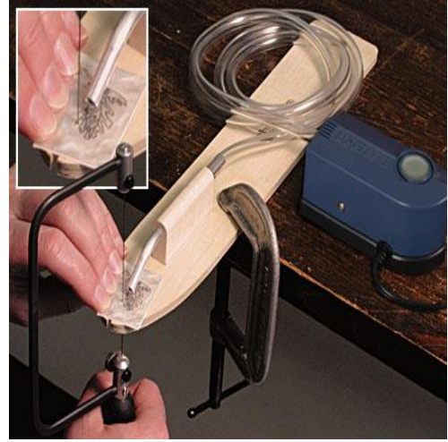
Resim 1.8: Şablonun tezgâha bağlanması ve kesimi
