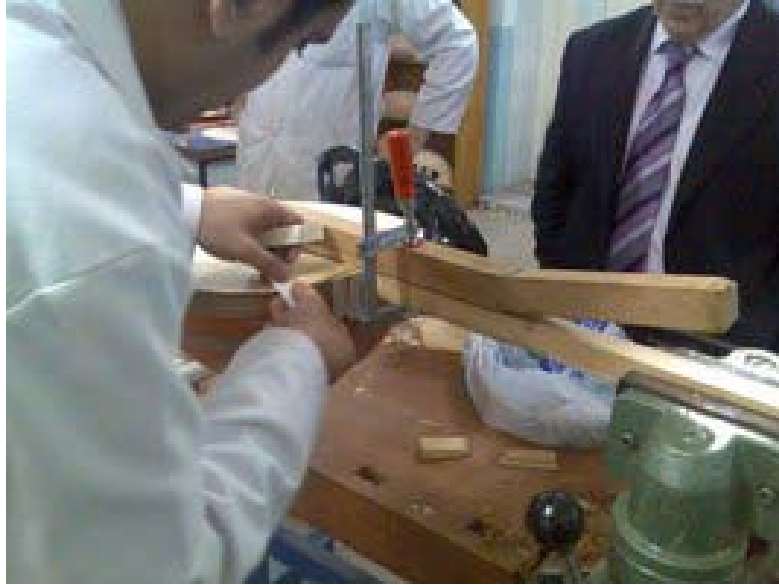
Resim 2.4: Tekneye kırlangıçkuyruğu açma
