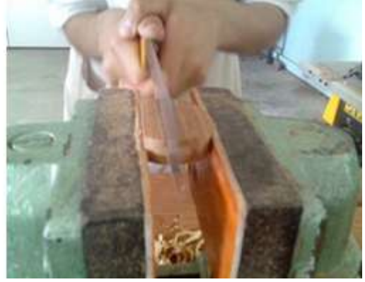
Resim 1.19: Tel takacağının kesilmesi
