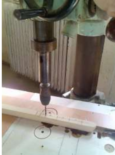
Resim 3.4: Burguluk yerlerinin dikey delik makinesinde delinmesi
