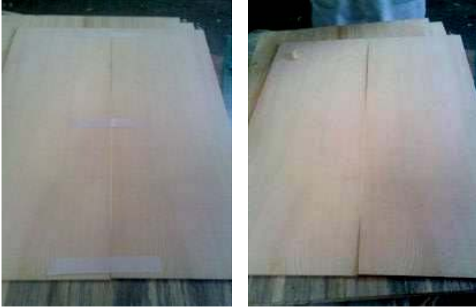
Resim 1.6: Ses tablosunun alıştırılmasının tamamlanması ve yapıştırılması
