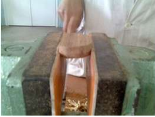
Resim 1.18: Tel takacağının mengeneyle bağlanması
