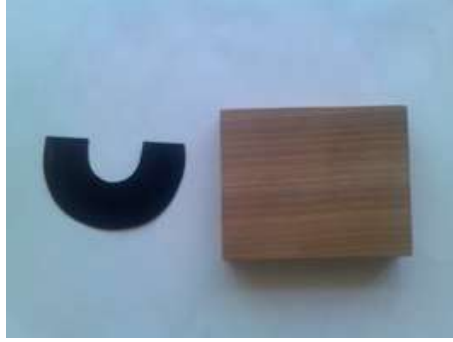
Resim 1.7: Aynalık şablonu ve ağaç malzeme
