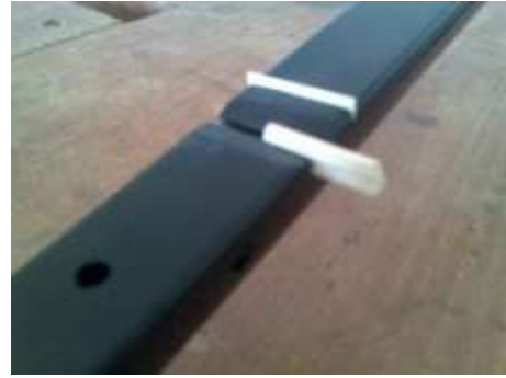
Resim 2.11: Köprünün yuvasına alıştırılması
