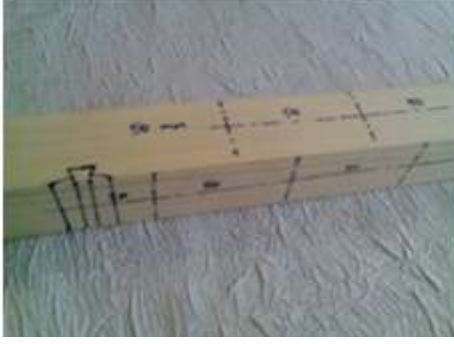
Resim 2.7: Köprünün şablona göre markalanması ve yerinin hazırlanması
