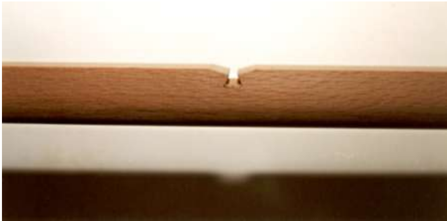
Resim 2.6: Köprünün sap üzerinde hazırlanmış hâli
