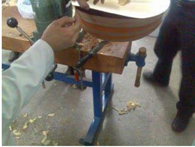
Resim 2.3: Tekneye kırlangıçkuyruğu açma
