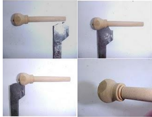
Resim 1.7: Burgunun yapılması ve kalıpla kontrolü
