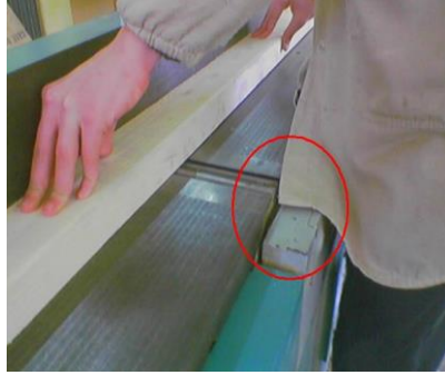
Resim 2.14: İş önlüğünün makineye sıkışması (yanlış)
