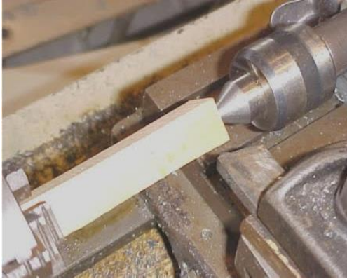
Resim 1.7: Burgunun yapılması ve kalıpla kontrolü
