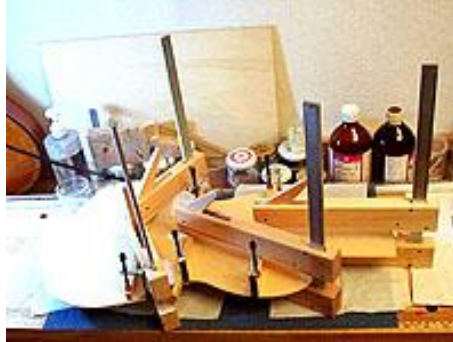
Resim 1.18: Eksantrik kollu iřkencenin gitarda uygulaması
