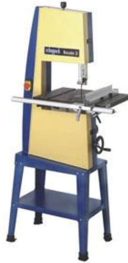
Resim 1.1: Şerit testere laması ve masa tipi şerit testere makinesi
