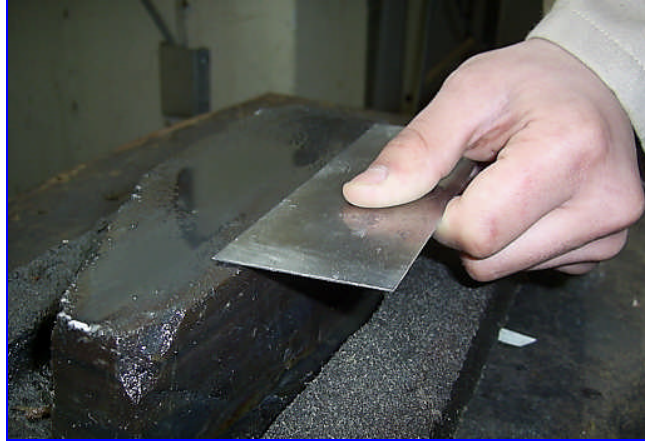
Resim 2.5: Sistirenin yağ taşında çapaklarının düşürülmesi
