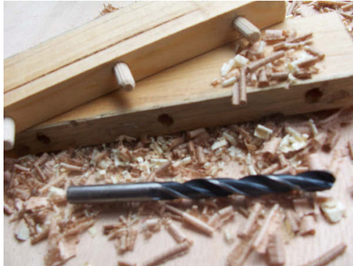
Resim 1.1: Kavelalı en birleştirme
