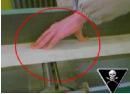
Resim 2.13: Makinede yanlış çalışma
