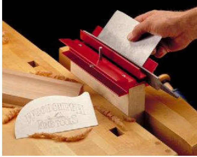
Resim 2.8: Sistirenin eğelenmesi
