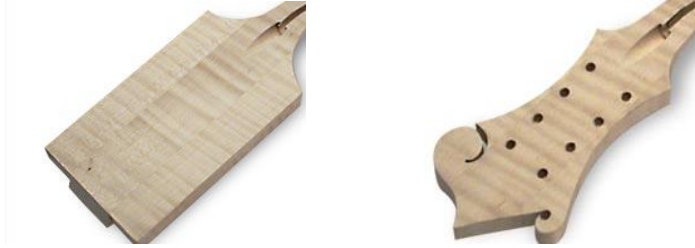
Resim 2.2: Freze makinesinde sapa form vermek
