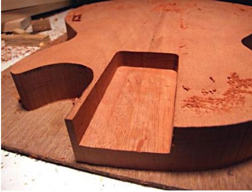
Resim 2.10: Gitar sap takozunun boşaltılması
