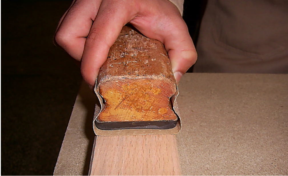
Resim 2.13: Zımpara takozu kullanımı
