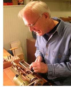
Resim 1.2: Elle çalışılan torna makinesi ve elle çalışma
