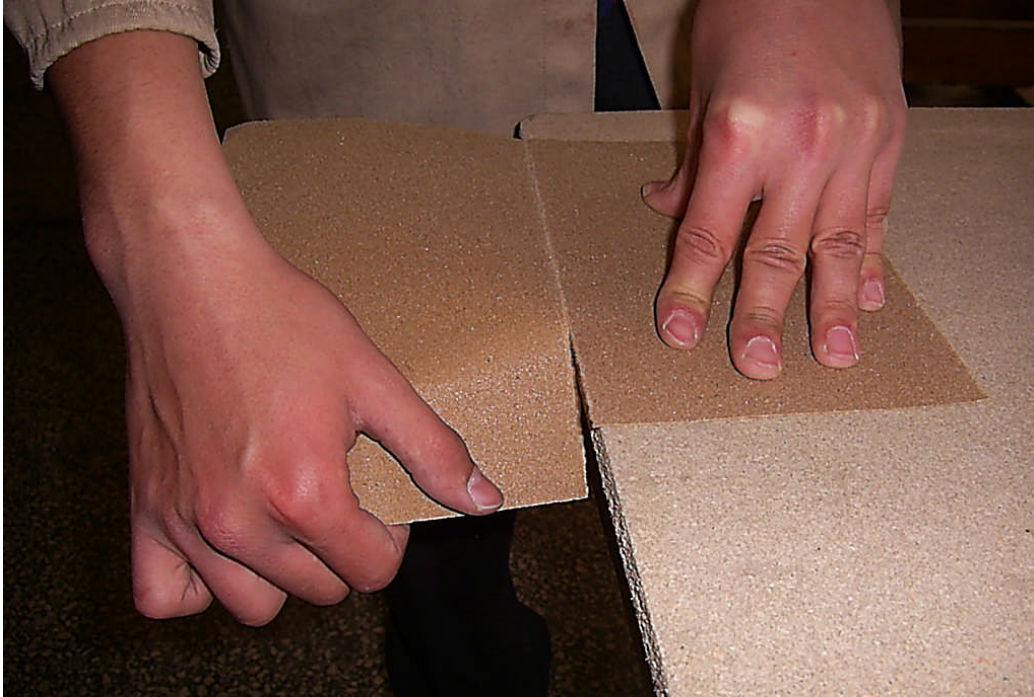
Resim 2.11: Zımpara tabakasının kesimi
