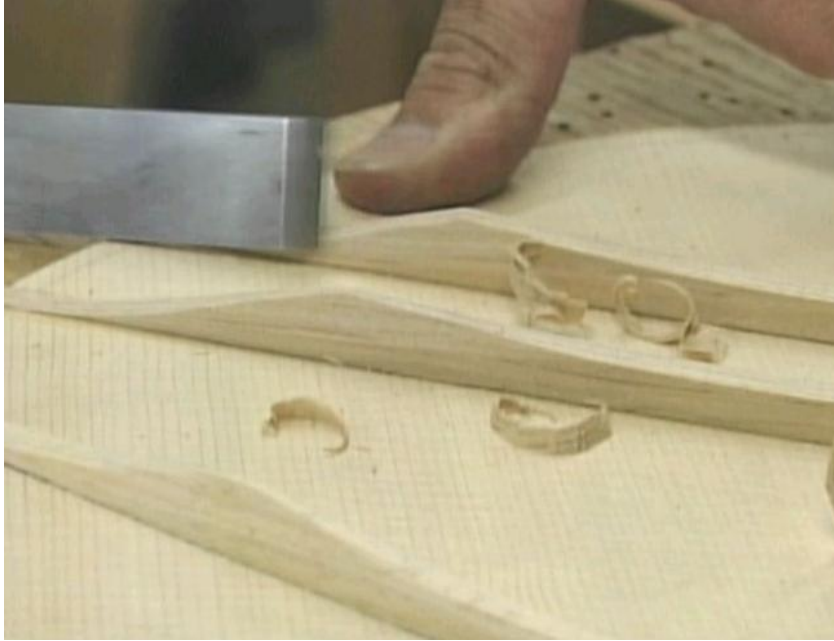
Resim 1.4: Düz kalemle parça tıraşlama
