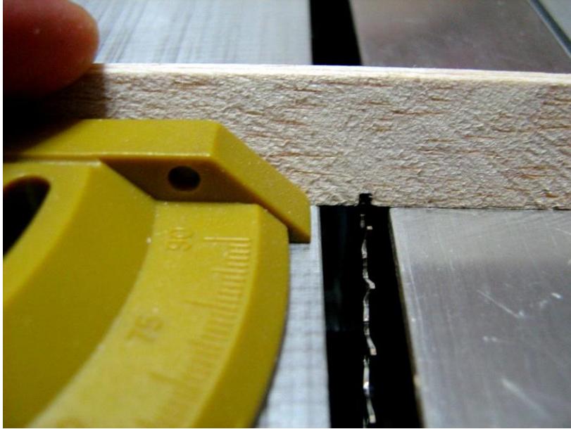
Resim 3.4: Kanal açma-testere boşluğu
