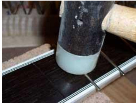
Resim 1.11: Fret çakmada plastik tokmak kullanımı
