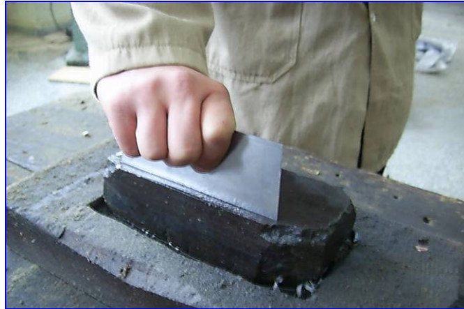
Resim 2.4: Sistirenin yağ taşında bilenmesi
