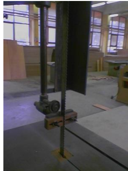
Resim 1.8: Üst kılavuz düzeni
