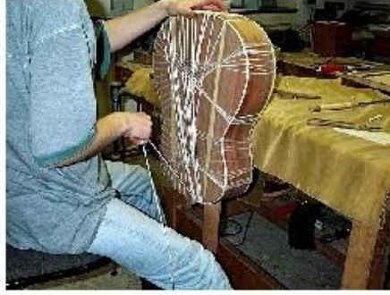
Resim 1.21: Gitarın filatolarının selobantla yapıştırılması
