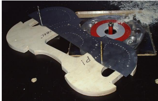
Resim 2.3: Kalıbın yatay freze makinesinde temizlenmesi
