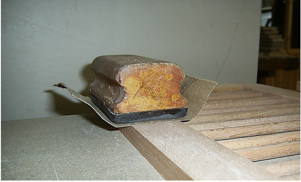
Resim 2.12: Zımpara takozuna zımparanın sarılması
