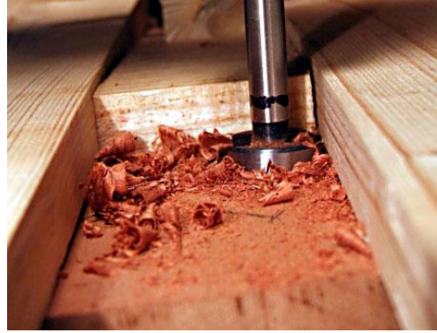
Resim 2.10: Gitar sap takozunun boşaltılması
