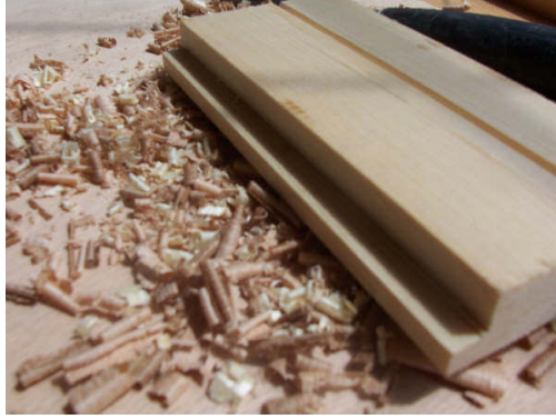
Resim 1.2: Lambalı en birleştirme
