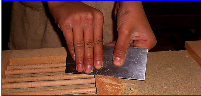
Resim 2.2: Sistireleme teknięi
