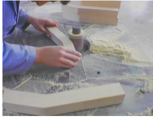
Resim 4.2: Top zımparada dış bükey temizleme
