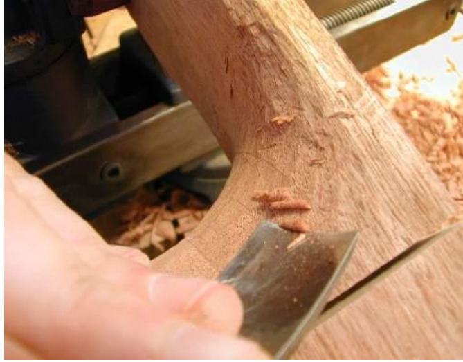
Resim 1.5: Eğmeçli yüzey yontulması
