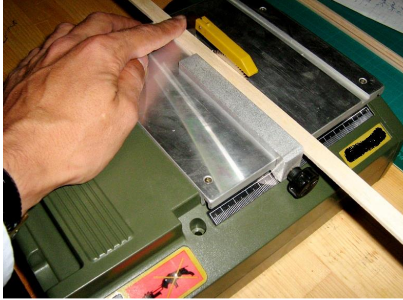
Resim 3.7: Kalınlık çıkarma-ayarlanabilir siper
