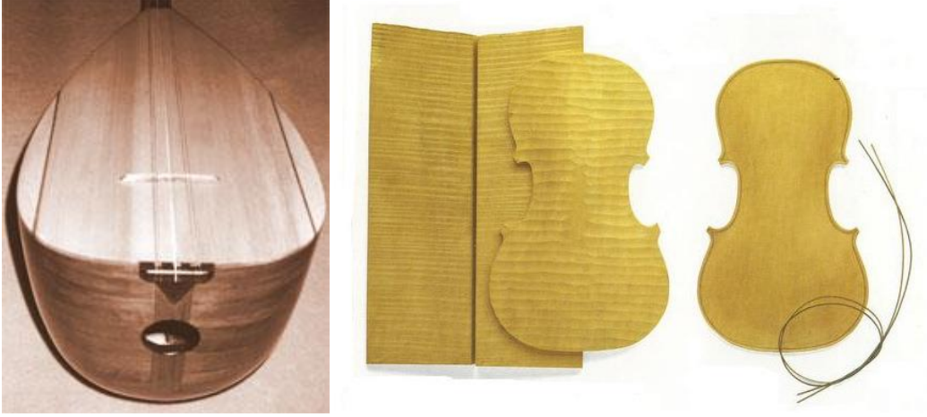
Resim 3.3: Filato yerleştirilmiş bağlama ve keman tablası
