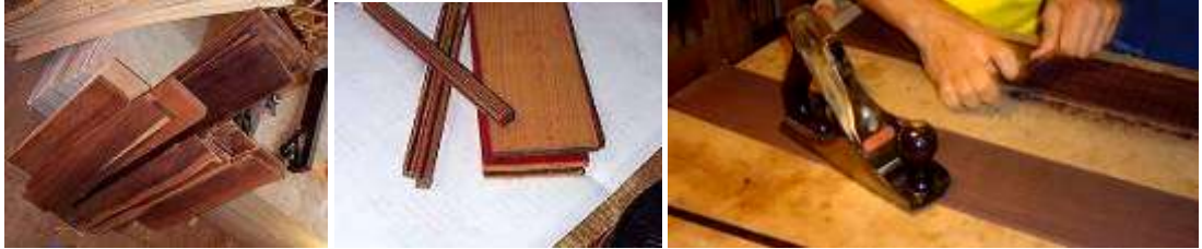
Resim 2.6: Klavye ağacının ölçülendirilmesi
