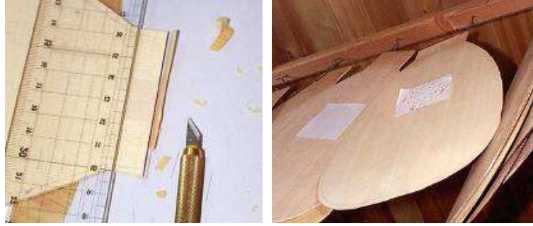
Resim 1.11: Kesilmiş ses tablosu
