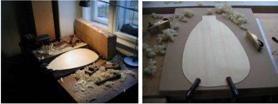
Resim 1.10: Ses tablosunun tezgâh üzerinde kesilmesi
