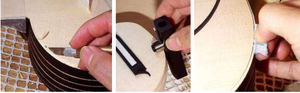
Resim 1.24: Filato kanalının elle ve özel aparatla açılması ve kanalın zımparalanması
