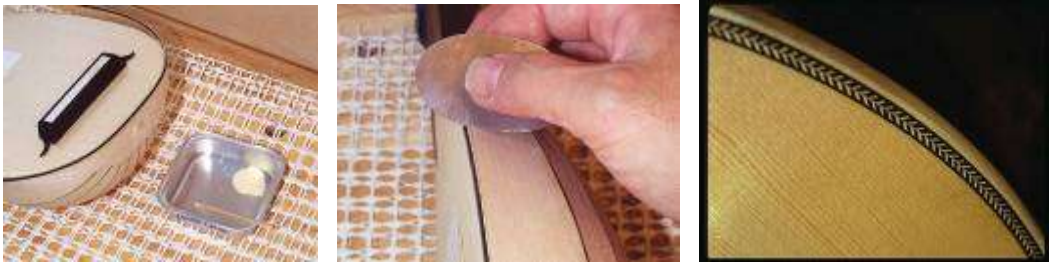
Resim 1.25: Filatonun açılan kanala tutkallanması ve sistirelenmesi (desenli filato)
