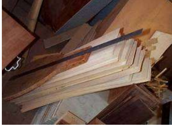
Resim 1.5: Biçilmiş ve kurumaya bırakılmış ses tabloları
