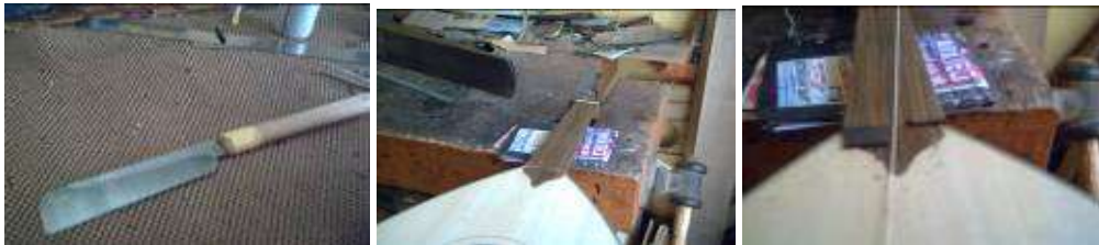
Resim 2.13: Çekme testere ve mengeneye sıkıştırılmış lavta
