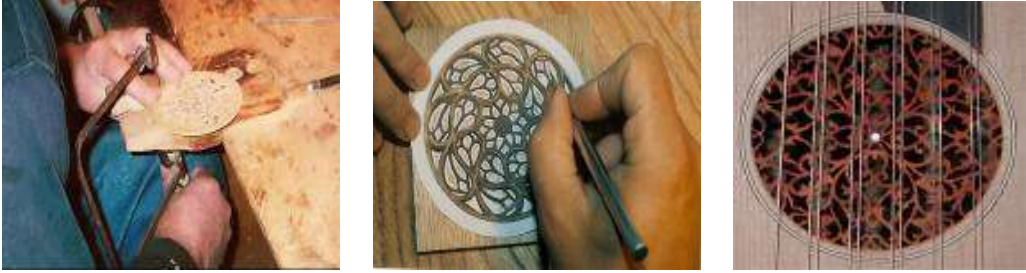
Resim 1.14: Ses tablosunda kafes yeri boşaltılarak kıl testeresiyle hazırlanan kafes
