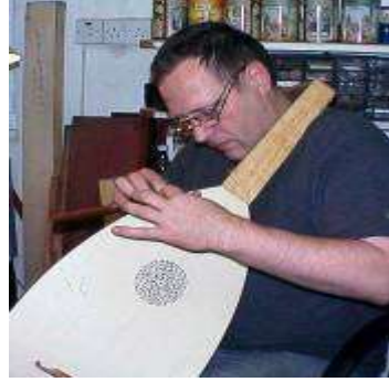
Resim 1.22: Fazlalıkların oyma kalemiyle temizlenmesi
