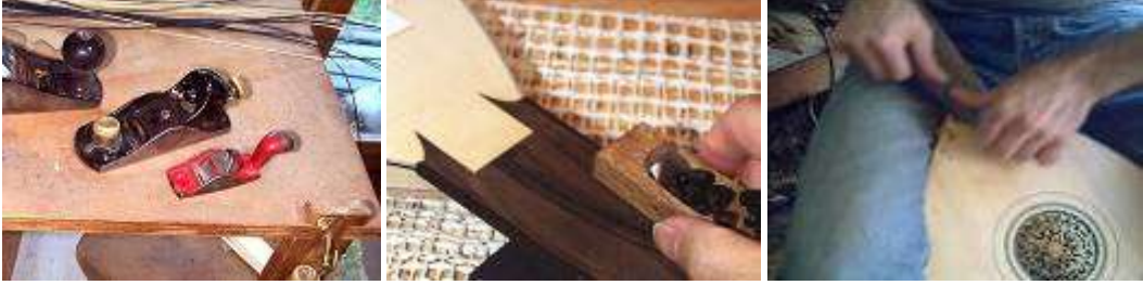
Resim 2.14: Klavyenin rendelenmesi ve sistirelenmesi
