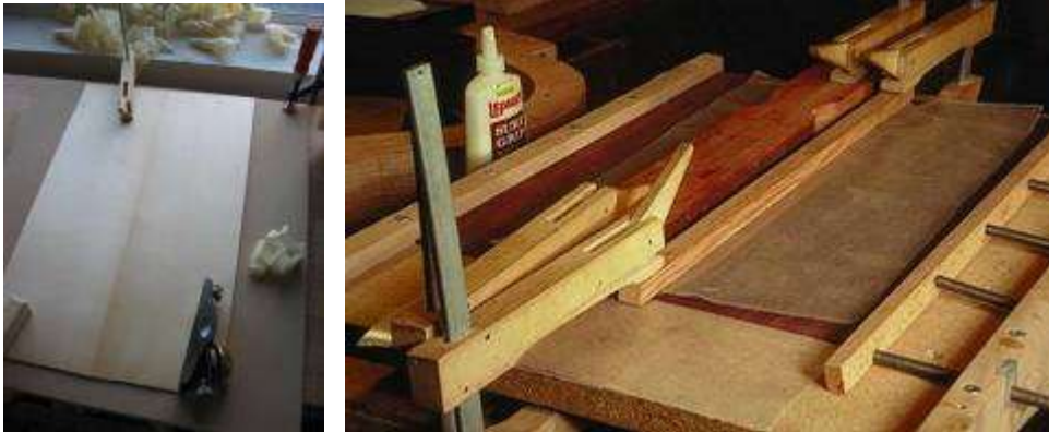
Resim 1.8: Ses tablosunun iki parçasının birbirine tutkallanması
