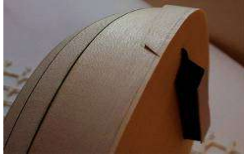
Resim 1.23: Fazlalıkların sistireyle temizlenmesi
