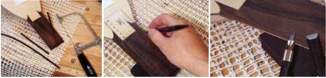
Resim 2.8: Filato kısmının kesilmesi
