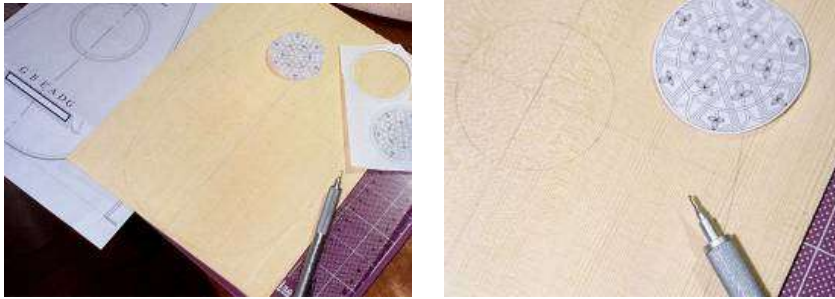
Resim 1.12: Ses tablosunda kafesin yerinin belirlenmesi ve çizilmesi
