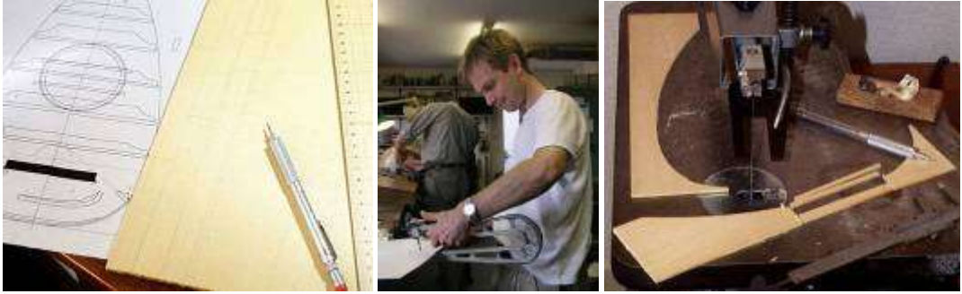
Resim 1.9: Ses tablosunun markalanması ve dekupajla kesilmesi
