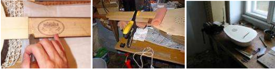
Resim 2.12: Klavye yerinin temizlenerek klavyenin yapıştırılması
