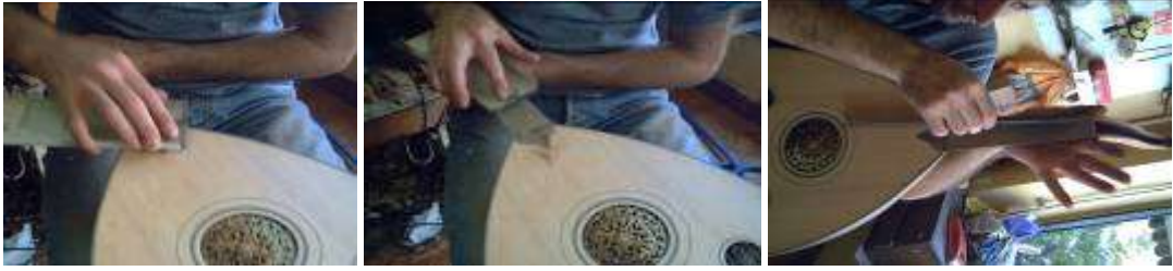
Resim 2.15: Klavyenin zımparalanması ve kontrol edilmesi
