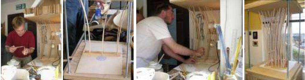
Resim 1.17: Balkonlara tutkal sürülerek ela çubuklarıyla yapıştırılması
