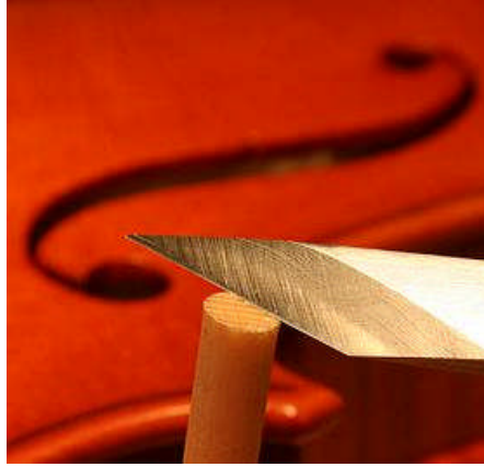
Resim 4. 2: Can direğinin tablo bombelerine uygun kesilmesi
