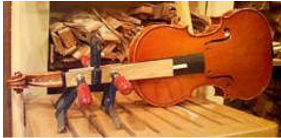
Resim 2.1: Tuşenin sapa montajı
