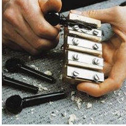
Resim 2.5: Burguların burgu tıraşı ile konikleştirilmesi
