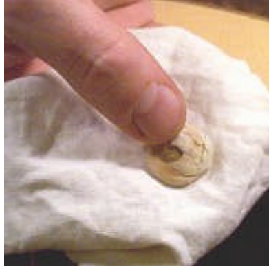
Resim 1.9: Tampon yaparak gomalak uygulanması
