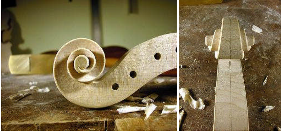
Resim 1.9: Salyangozun estetik şekillendirilmesi
