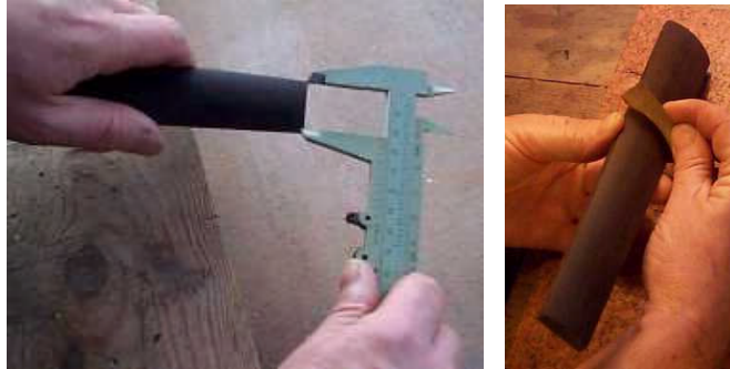
Resim 1.12: Tuşenin ölçü ve bombe kontrolünün yapılması
