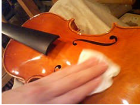
Resim 1.9: Ses tablosunun parlatılması
