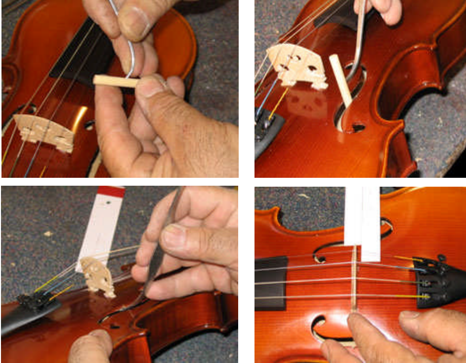
Resim 4.3: Can direğinin takılması
