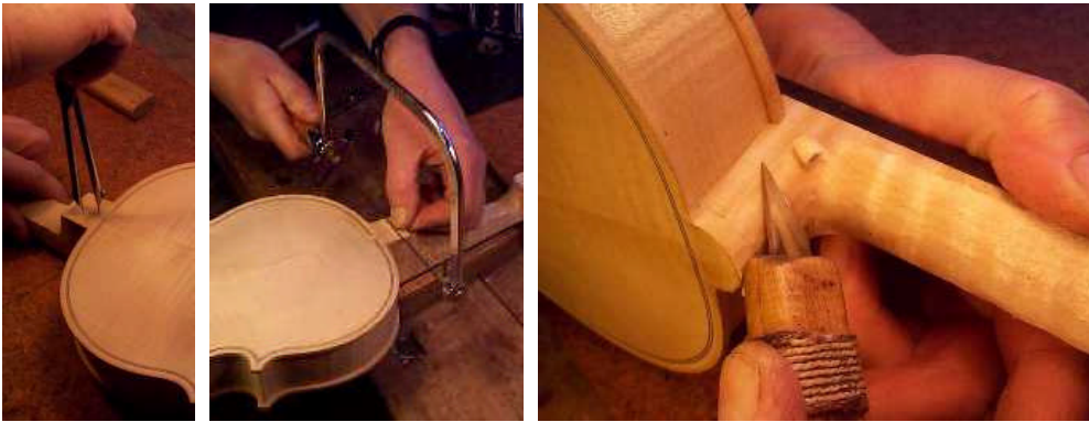
Resim 2.5: Sap dibine form verilmesi
