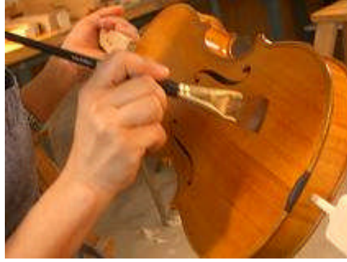
Resim 1.6: Cila uygulamalarında kullanılan fırçalar
