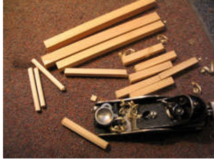
Resim 3.2: Can direğinin hazırlanması
