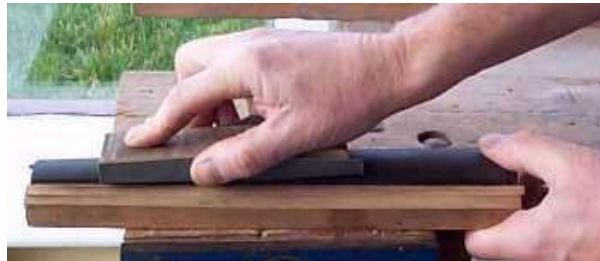
Resim 1.13: Tuşenin üst yüzeyinin zımpara ile düzeltilmesi
