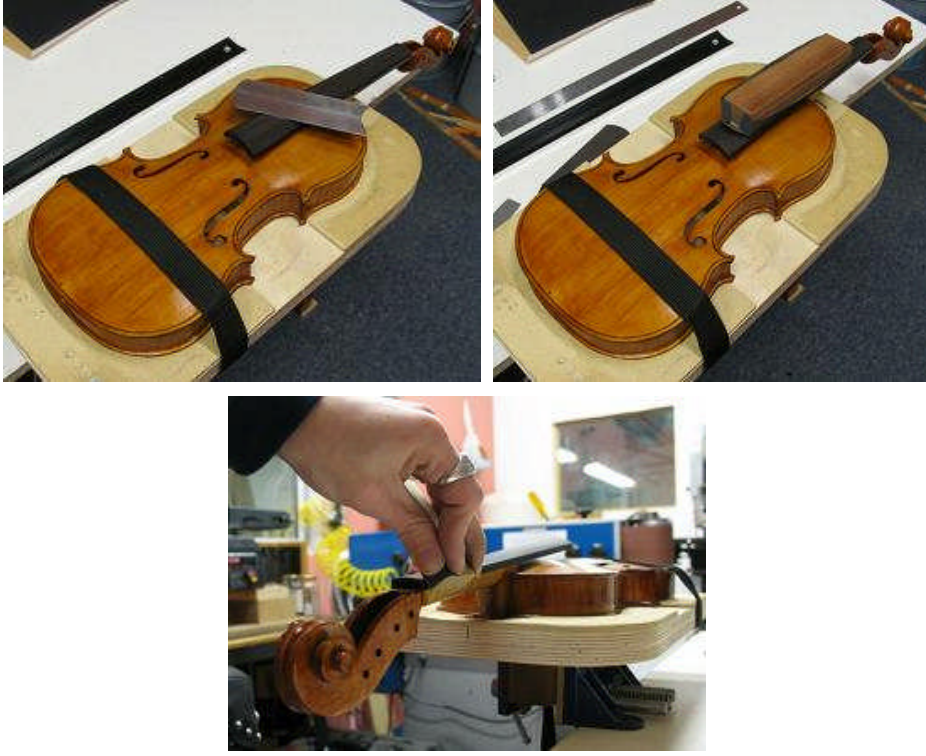
Resim 2.2: Tuşenin temizlenmesi
