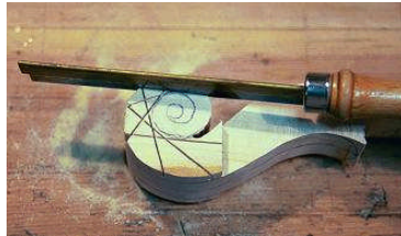
Resim 1.7: Salyangozun şekillendirilmesi
