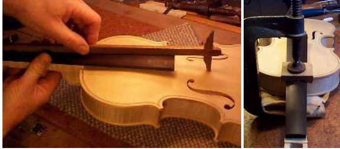
Resim 2.4: Sapın armonik kasaya yapıştırılması
