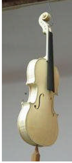
Resim 1.2: Kemanın ciladan önce bekletilmesi
