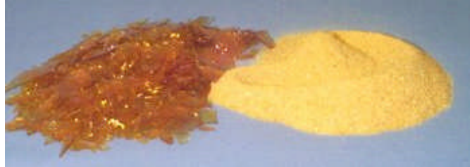
Resim 1.3: Pul hâalde ve çekilerek toz hâline getirilmiş gomalak
