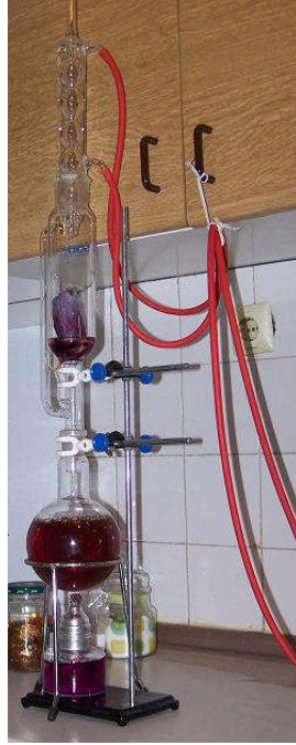
Resim 1.5: Renkli cila yapımında kullanılan exraktör
