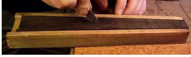
Resim 1.14: Tuşenin alt kavisinin sistre ile şekillendirilmesi
