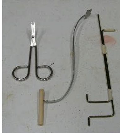
Resim 4.1: Can direği takılmasında kullanılan bazı aletler
