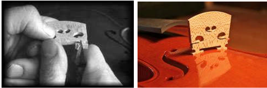
Resim 4.6: Köprü ayaklarının ses tablosu bombesine alıştırılması
